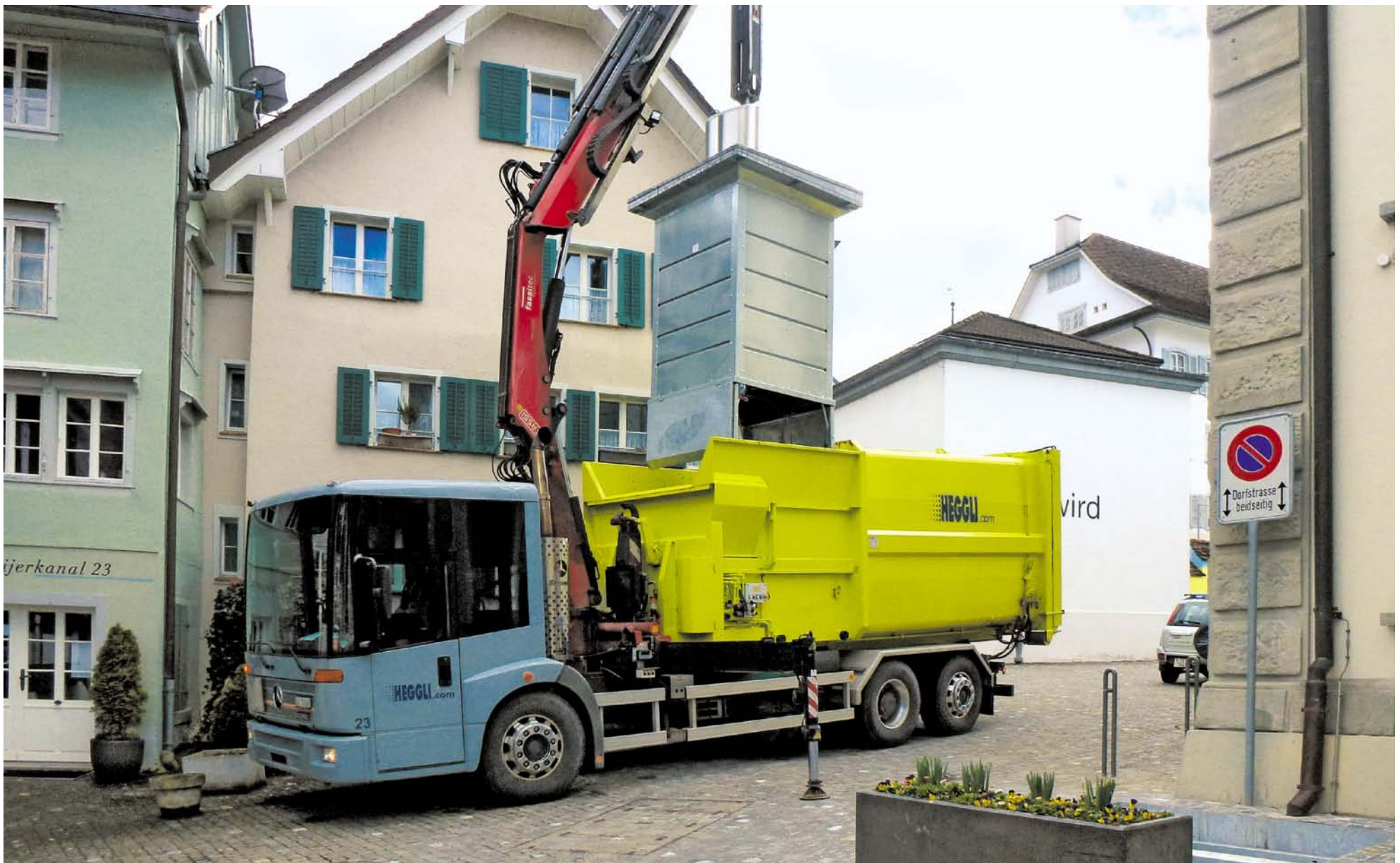
Leeren eines Unterflurcontainers bei der Burgbachtturnhalle in Zug. Anschliessend wird der Container wieder in den Schacht unmittelbar vor der Parkverbots- tafel abgesenkt.
