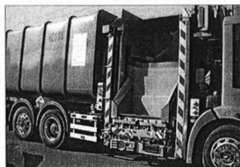
Die hochfahrende Schüttung (unten) und die Verdichtungseinheit sind seitlich am Fahrzeug, zwischen Fahrerhaus und Container, platziert. BILDER: STEFAN GFELLER
