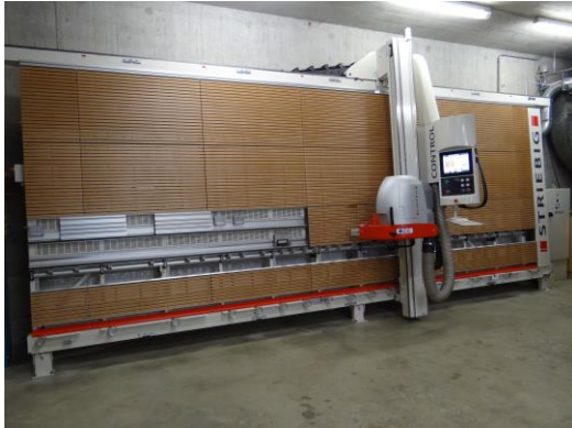
Neue Striebig Plattensäge mit Bedienungseinheit, welche auch durch geschulte Gefangene bedient werden kann.
