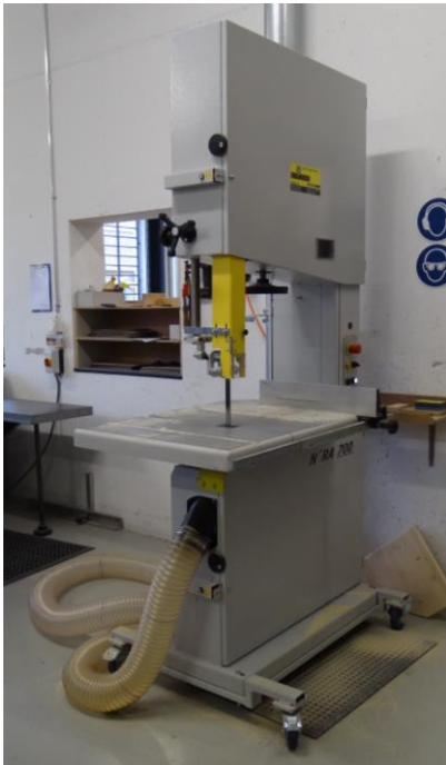
Die neue Bandmaschine mit Anschluss an die Filteranlage
