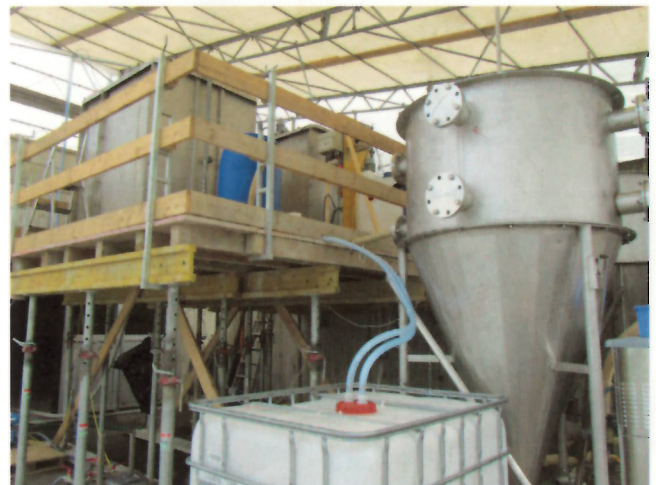
Abb. 1: Versuchsanordnung zur Pilotierung der Dosierung von PAK in die biologische Reinigung (Foto: KomS)
