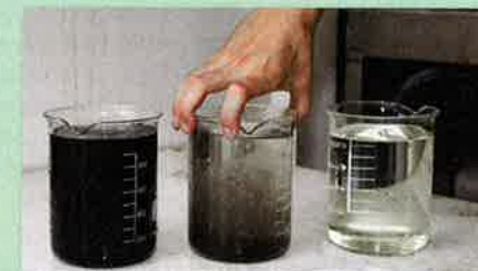
PAK-Abscheidung (v.l.n.r.): In der Kontaktzone, bei der Sedimentation, Ablauf vor und nach der Lamellenklärung.
