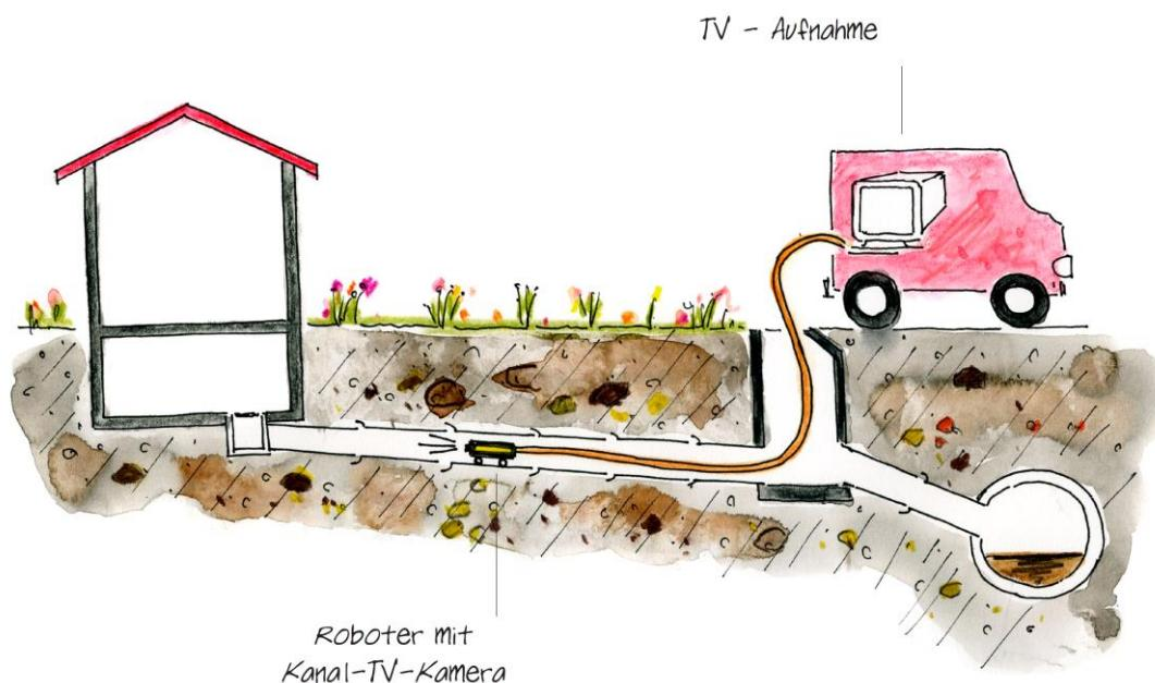
Sind die Entwässerungsanlagen Ihrer Liegenschaft seit längerer Zeit in Betrieb, ist es sinnvoll, den Zustand der Anlagen - nach vorgängiger Reinigung - durch erfahrene Spezialfirmen für Kanalfernsehen begutachten zu lassen. Die Zustandsaufnahmen der Leitungen im Untergrund sollten regelmässig (**z.B. alle 10 Jahre**) erfolgen. Dieses Vorgehen verschont Sie vor unangenehmen Überraschungen.
