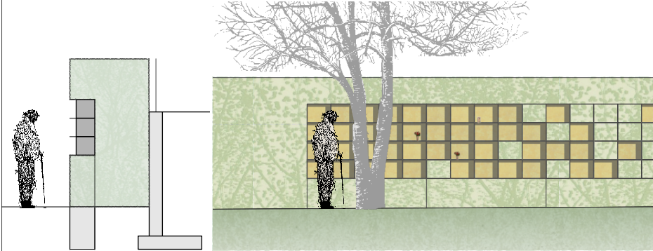
Urnenwand 1:50 Schnitt und Ansicht
