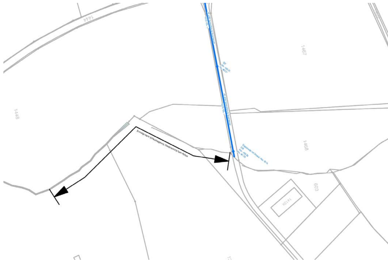
Abb. 3.1 Ableitung Sickerwasser direkt in Bach (Auszug aus Plan Nr. SB.080, 30. 09. 2014))
