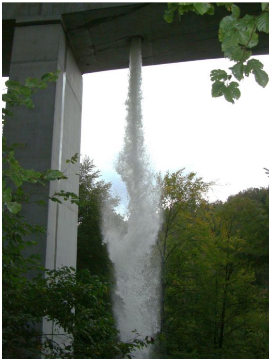
Abbildung 3: Lufteintrag und Auffächerung des Ausflusstrahls beim Auslassversuch vom 26.9.2012
