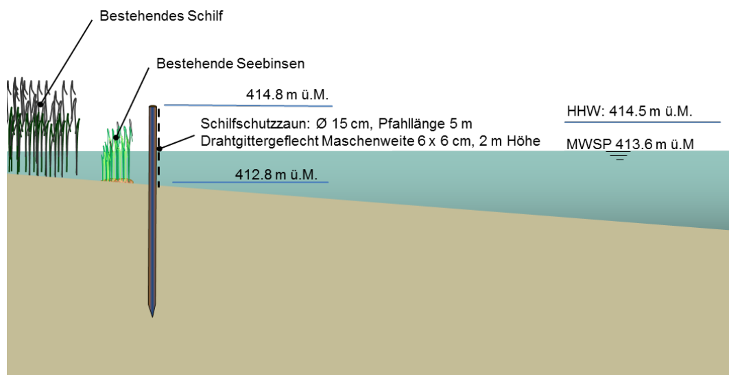
Abbildung 4: Längsschnitt durch das Ufer mit Schutzzaun.
