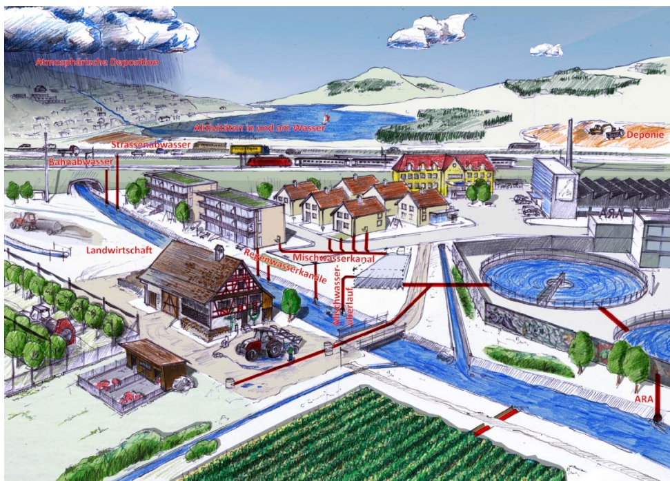
Abb.2 Abwasserproduktion bei der menschlichen Tätigkeit und Eintrittswege in die Gewässer (BAFU, 2015)
