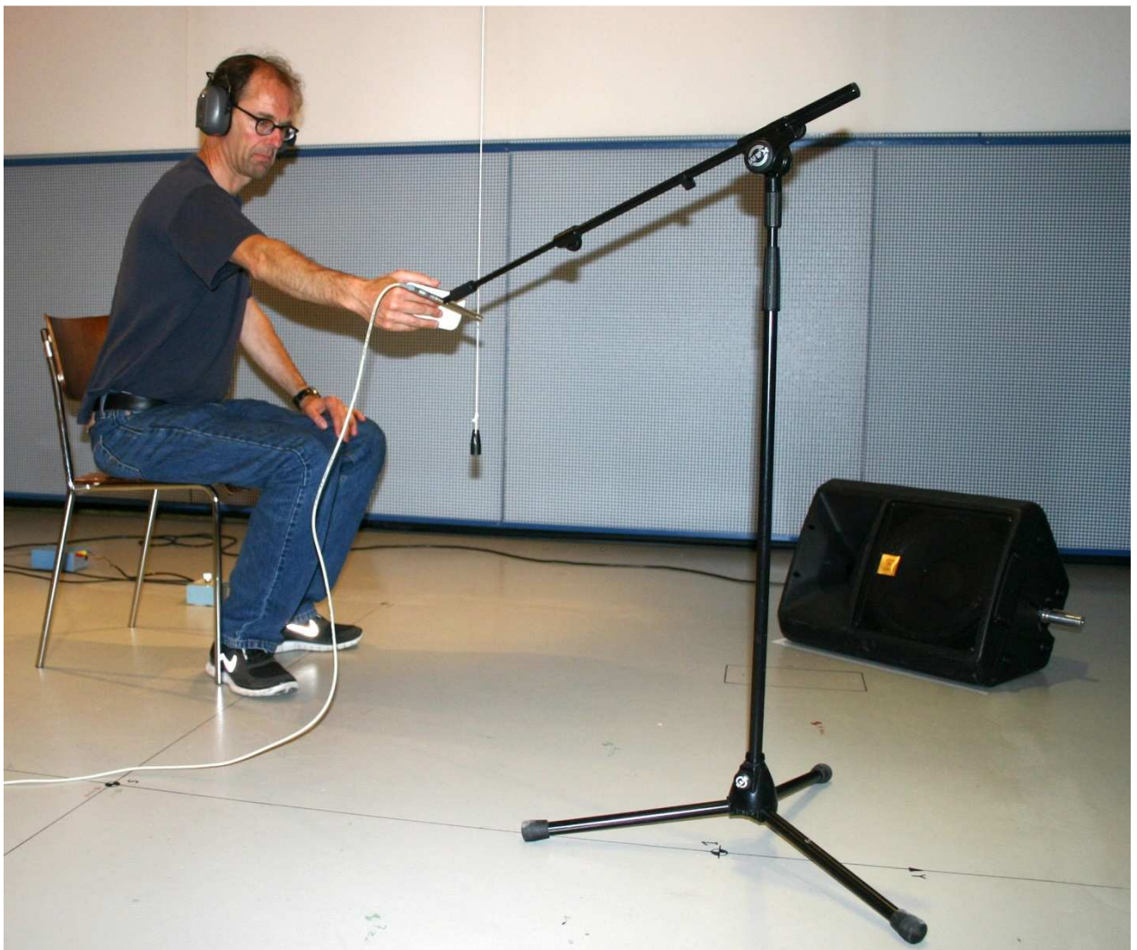
Abbildung 1: Messkonfiguration im reflexionsarmen Raum mit hartem Boden.
