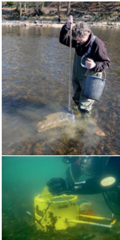
Probenahme der Wasserwirbellosen mittels Kicknetz im wathbaren Bereich (oben) und Surber Sampler mittels Taucher in der Flussmitte (unten).
